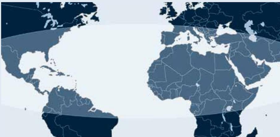
Grundsätzlich ist in Salzwasser mindestens eine A4 Edeldstahlgüte zu empfehlen. In dem gekennzeichneten Bereich können die Wassertemperaturen deutlich über 27°C steigen. In diesem Fall empfehlen wir aufgrund der deutlich höheren Korrosionsbeständigkeit die **aRö® duplex premium**.
